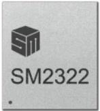
이 싱글칩 솔루션은 기존의 설계 방식에서 요구하는 USB 브리지 칩을 제거하여 BOM(Bill of Materials) 비용과 전력 소모를 모두 감소시킨다. 새로운 SM2322 컨트롤러는 실리콘 모션만의 NANDXtend® 4KB LDPC 에라-교정 기술을 사용하여 3D TLC/QLC NAND의 내구성과 데이터 유지 능력을 향상시켜서 외장 포터블 SSD의 성능과 용량을 더욱 업그레이드한다. 이 컨트롤러는 SRAM EEC와 종단간 데이터 경로 보호(end-to-end data path protection)를 통해 종합적인 데이터 무결성을 보장한다. 또한 SM2322는 AES 256-bit 암호화와 지문 보안 기능을 탑재하고 TCG(Trusted Computing Group) Opal 규격을 완전히 준수하여 가장 높은 수준의 보안 기준을 충족시킴으로써 최고의 데이터 보안을 제공한다.
