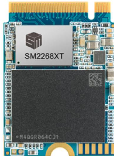
SM2268XT采用双核ARM R8 CPU，具有4个16Gb/s PCIe数据流的通道，支持4个NAND通道，每个通道最高可达3,200 MT/s，从而使设计人员能够利用下一代高速TLC和QLC 3D NAND闪存的较高吞吐量。其多核设计可自动平衡计算负载，以提供业界领先的7,400 MB/s和6,500 MB/s连续读写速度和1,200K IOPS随机读写速度。此外，其先进的架构可实现较低的功耗和严格的数据保护，在具成本效益的DRAM-less PCIe Gen4 NVMe SSD解决方案中提供高性能和高可靠性。
