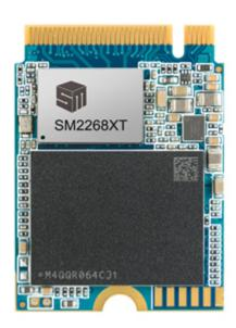
SM2268XT搭載雙核心ARM R8 CPU, 內含四個PCIe 16Gb/s資料匯流排, 並支援四個NAND 通道, 每個通道最高可達3,200 MT/s, 讓SSD設計人員能夠充分利用次世代高速TLC和QLC 3D NAND, 開發出更高效能SSD。其多核心設計可自動平衡運算負荷, 以提供領先業界的超高效能, 循序讀/寫速度可達7,400/6,500 MB/s, 隨機讀寫可達1,200K IOPS。此外, 其先進的架構有助於提供更低耗電及更嚴密的資料保護, 為具備成本效益的DRAM-less PCIe Gen4 NVMe SSD解決方案帶來更高效能與高可靠性。
